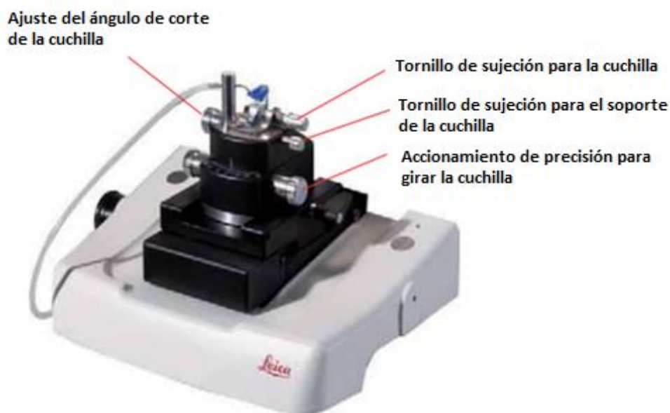
Fig. 2: Disposición del portacuchilla en ultramicrotomo Leica EM KMR3
